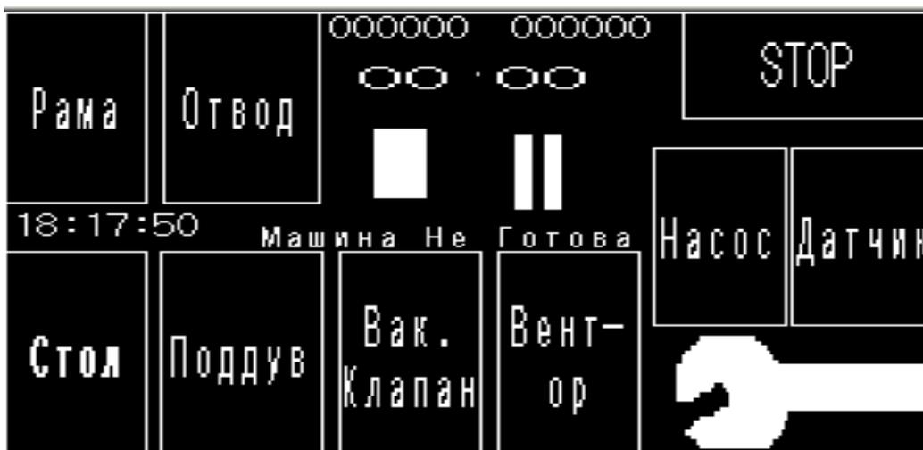
4. Включить **Насос**(питание Вакуумного насоса), **Датчик**(Датчик уровня). Включение **Насоса** регулирует дальнейшую работу **Вак. Клапана**.
